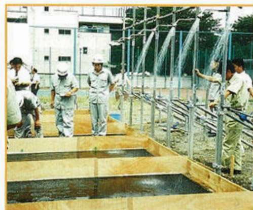
試験体への散水状況
