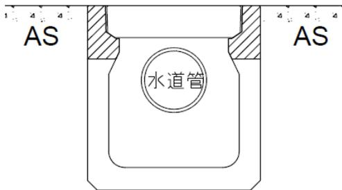
・側溝内に水道管が通っている為、掘削が出来ない。
